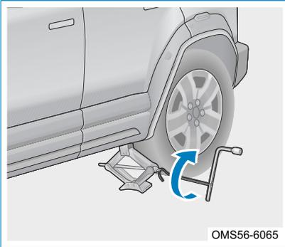
Paso 6: Coloque el balancín de gato en el gato y la llave de perno de rueda en el balancín de gato, gire en sentido horario. Levante el vehículo con un gato hasta que las ruedas estén ligeramente separadas del suelo.
