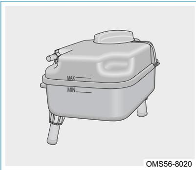
El vehículo debe estacionarse en una tierra nivelada al verificar el nivel del líquido refrigerante. Verifique si el nivel de refrigerante en el depósito está entre las líneas MAX y MIN. Si el refrigerante en el depósito está hirviendo, la operación puede realizarse después de que el refrigerante se haya enfriado. Si el nivel de refrigerante es inferior a la línea MIN, añada refrigerante al depósito de refrigerante de acuerdo con el procedimiento especificado.
