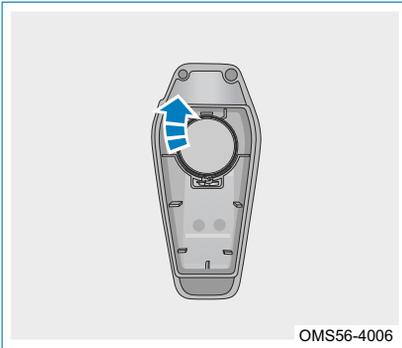
2. Retire la batería del tablero de circuito e instale una nueva con positivo (+) hacia arriba.
