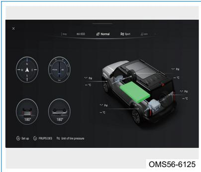
Cuando la velocidad del vehículo no sea inferior a 30 km/h durante un cierto tiempo, se mostrarán los valores de presión y temperatura de los neumáticos.
