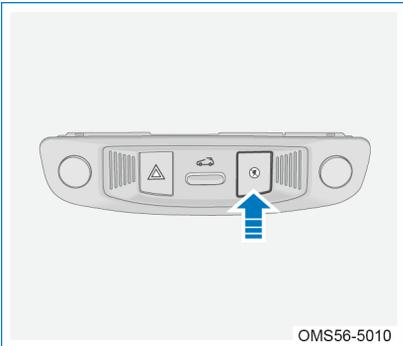
Pulse prolongadamente el interruptor de apagado de emergencia durante 3 segundos o presione el interruptor de apagado de emergencia continuamente durante 3 veces en 3 segundos y se apaga el vehículo.
