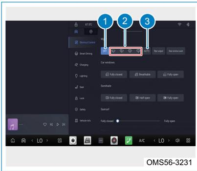
En la pantalla de ajuste "Control Rápido" de la pantalla "Control del vehículo" del sistema de audio, active/desactive el limpiaparabrisas.
