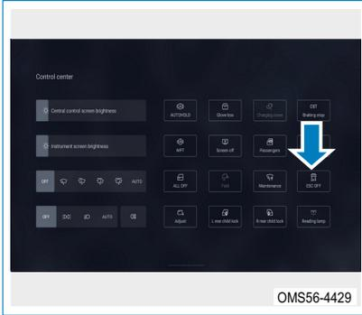
**Botón ESC OFF:** Con el vehículo encendido, deslice hacia abajo desde la parte superior de la pantalla del sistema de audio para ingresar al "Centro de control" y al botón "ESC OFF".
