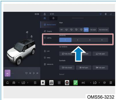
Si necesita controlar la frecuencia del limpiaparabrisas con mayor precisión, puede ajustar la sensibilidad del limpiaparabrisas en esta pantalla del sistema de audio en modo automático.
