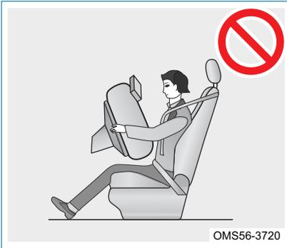
Mantenga siempre limpia la tura de inflado de airbag. Está prohibido colocar cualquier cosa (teléfono, etc.) entre el ocupante y el airbag. Está prohibido fijar o colocar cualquier objeto sobre o cerca de la cubierta de airbag. Si hay un objeto entre el ocupante y el airbag, es posible que el airbag no se despliegue de acuerdo con la ruta de diseño, o el airbag puede empujar objetos al cuerpo del ocupante, causando lesiones graves o incluso la muerte.
