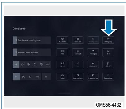
Botón CST: Con el vehículo encendido, deslice hacia abajo desde la parte superior de la pantalla del sistema de audio para ingresar al "Centro de control" y al botón "CST".
