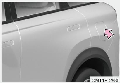
Paso 1: Después de desbloquear el vehículo, empuje la tapa del tanque de combustible y se abrirá;
