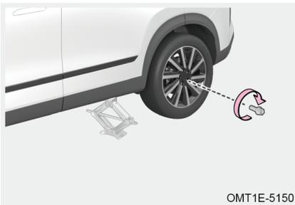
Paso 2: Cuando instala los pernos de rueda, atornille todos los pernos de rueda en sentido horario con la mano. Luego enderece el neumático de repuesto y apriete previamente todos los pernos de rueda con la llave de perno de rueda;
