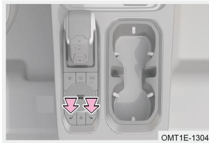
Método 2: Después de arrancar el vehículo, presione el interruptor de la calefacción del asiento delantero en la consola auxiliar del tablero, es la calefacción del nivel 3 (3 indicadores encendidos). Cada vez que se pulsa el interruptor, el nivel de calefacción se reduce en un nivel. Púlselo por cuarta vez para desactivar la calefacción del asiento.
