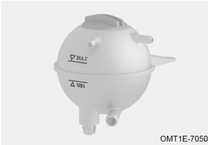
Quando el motor está frío, el nivel de refrigerante debe estar entre las marcas "MIN" y "MAX". Si el nivel es igual o inferior a la marca "MIN", agregue el refrigerante y contacte con la estación de servicio autorizada para una inspección y reparación de inmediato.
