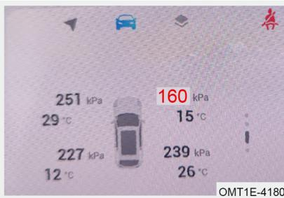
Cuando la presión de neumático es inferior a 192 bar y la velocidad no es inferior a 25 km/h por un período de tiempo, el sistema enviará una advertencia de baja presión, el símbolo de la rueda correspondiente parpadeará, se mostrará el valor actual de la presión de neumático y el indicador amarillo "!" en el cuadro de instrumentos permanecerá encendido.
