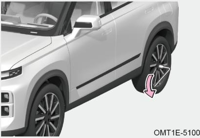
Paso 2: Coloque la llave de perno de rueda en el perno del neumático desinflado, coloque la manija en el lado izquierdo, sostenga el extremo de la llave y empuje hacia abajo, afloje cada perno del neumático desinflado aproximadamente media vuelta;
