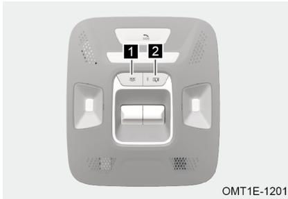
**1** Interruptor de luces de lectura: Presione el interruptor "☀️" para encender las luces de lectura, presione el interruptor nuevamente para apagar las luces de lectura.
