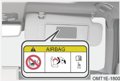
Esta pegatina está pegada en el visera del pasajero delantero y se utiliza para recordarle que el vehículo está equipado con airbag frontal (SRS). Se observen las siguientes precauciones:
