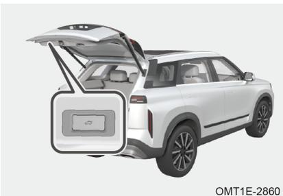
Método 1: Cuando el portón trasero eléctrico está abierto, ajústelo a la altura deseada; Presione largamente el interruptor "
