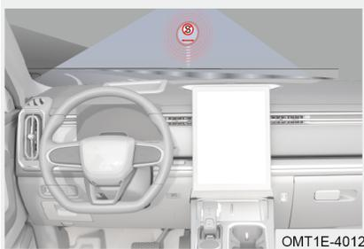
Cuando el sistema está encendido, la señal de prohibición de estacionamiento temporal/parmanente "Ⓢ" o la señal de prohibición de estacionamiento "Ⓟ" se reconoce y está dentro del tiempo de retención, y su vehículo está en la posición P durante un período de tiempo, el cuadro de instrumentos puede darle un sonido de alarma y parpadear la señal reconocida, recordándole que obedezca las normas de tráfico locales.
