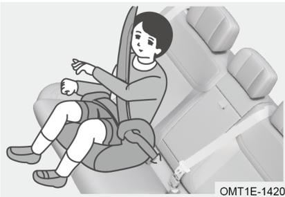
En el caso de los niños más grandes que no caben en un sistema de retención infantil con respaldo alto, pueden ocupar un asiento exterior de la segunda fila utilizando un asiento elevador, ya sea fijado en los puntos de anclaje inferiores o con cinturón, como se describe en las instrucciones proporcionadas por el fabricante del sistema de retención infantil.
