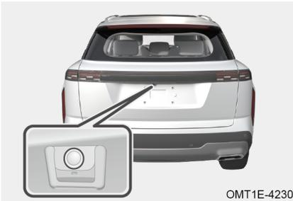
Posición de instalación de cámara trasera: ubicada en la parte central sobre la placa de matrícula trasera.
