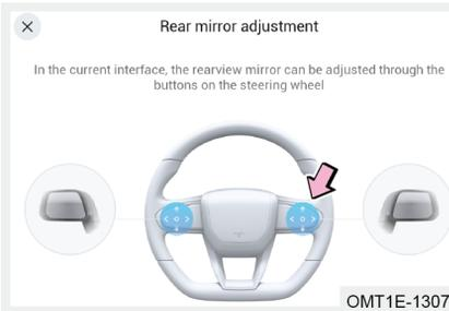
Gire la alimentación del vehículo en modo ON, Sistema de Audio - Centro del Vehículo - Confort del vehículo - Ajuste del espejo retrovisor.
