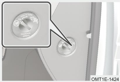
El interruptor de activación/desactivación del airbag está situado en el panel de instrumentos del lado del acompañante y es visible cuando se abre la puerta del acompañante.
