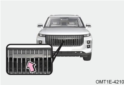
Posición de instalación de la cámara frontal: ubicada en la rejilla de admisión del parachoques delantero.
