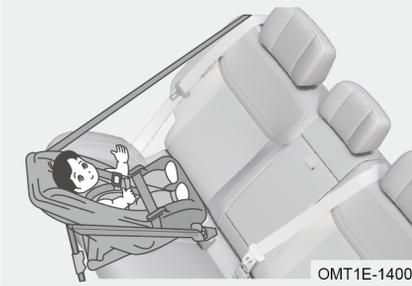
Un sistema de retención infantil orientado hacia atrás se instala para mirar hacia la parte trasera del vehículo. Instale un sistema de retención infantil orientado hacia atrás en el asiento del acompañante sólo si el airbag está desactivado. Se recomienda que los niños utilicen un sistema de retención infantil orientado hacia atrás hasta los 4 años de edad.
