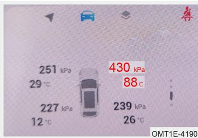
Cuando la temperatura de neumático es superior a 85°C y la velocidad no es inferior a 25 km/h por un período de tiempo, el sistema enviará una advertencia de alta temperatura, el símbolo de la rueda correspondiente parpadeará, se mostrará el valor actual de la temperatura de neumático y el indicador amarillo "(!)" en el cuadro de instrumentos permanecerá encendido.
