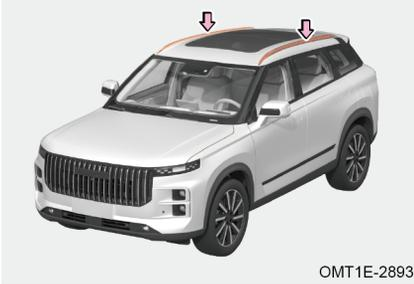
El portaequipajes de techo se utiliza para cargar cargas que puede soportar cargas de 75 kg. El sobrepeso causará daños en el portaequipajes, el techo del cuerpo y otros componentes, los diversos problemas causados por el sobrepeso no están cubiertos por la garantía.
