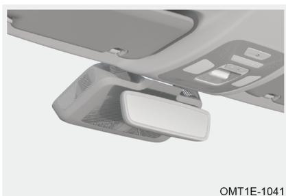
Cuando conduce por la noche, el sensor de luz instalado en la parte delantera/trasera del espejo retrovisor interior detecta automáticamente la luz reflejada de los faros de vehículos detrás y ajusta automáticamente el ángulo de lente para reducir la luz reflejada desde los faros de vehículos detrás.
