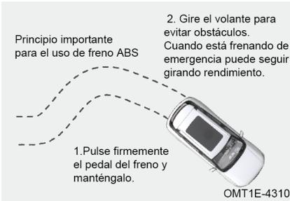
ABS no funciona durante el frenado normal y se encenderá inmediatamente solo en el frenado repentino (el pedal del freno se pulsa con ruido, asegurando el rendimiento del freno y el rendimiento de la dirección, si el espacio es suficiente, el vehículo también puede evitar obstáculos). Nunca suelte el pedal del freno en este caso.
