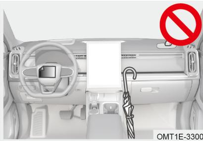
No ponga nada ni apoye nada contra las áreas tales como el panel de instrumentos, el volante y la parte inferior del tablero de instrumentos. Estos elementos pueden convertirse en proyectiles cuando se despliega el airbag del conductor o el pasajero delantero.
