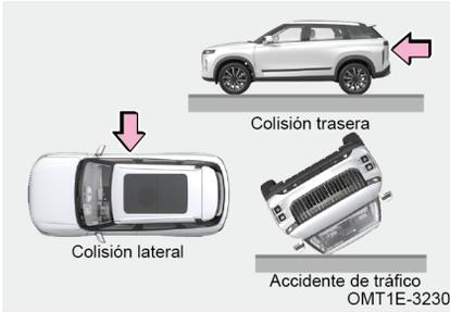
El airbag del conductor, el airbag del pasajero delantero y el airbag de rodillas del conductor (si está equipado) generalmente no se desplegarán si el vehículo está involucrado en una colisión lateral o trasera, si se vuelca o si está involucrado en una colisión frontal a baja velocidad.
