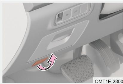
Paso 1: Tire de la palanca de liberación del capó y el capó se levantará ligeramente; Tire de él de nuevo y el capó se levanta un poco más.
