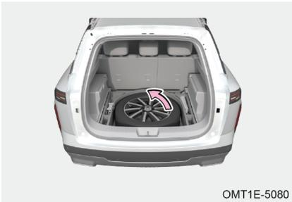
Paso 2: Gire el dispositivo de fijación del neumático de repuesto en sentido antihorario para retirarlo y luego saque el neumático.
