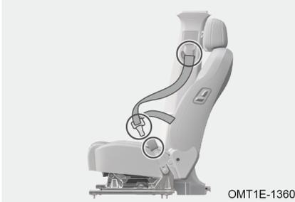
Compruebe los cinturones de seguridad regularmente en busca de cortes, deshilachados, cinturones sueltos o estirados (por ejemplo, después de un accidente de tráfico) si el cinturón de seguridad está dañado, por favor comuníquese con la estación de servicio autorizada para una inspección y reparación inmediatamente.
