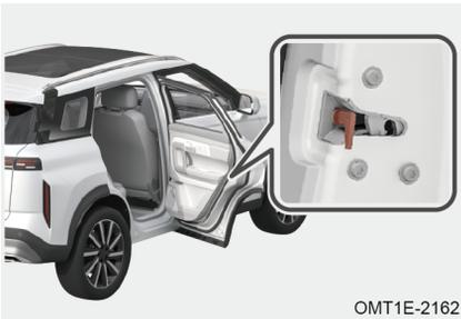
Cuando la batería se agota o se encuentra en una situación similar, el vehículo no puede bloquearse con energía eléctrica, en cuyo caso la puerta se puede bloquear con una función de bloqueo de emergencia.
