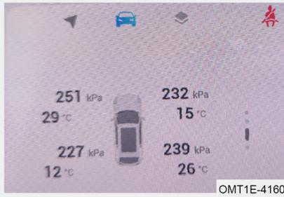
Cuando la velocidad de conducción del vehículo es superior a 30 km/h y el tiempo de conducción continua es superior a 45 s, el cuadro de instrumentos puede mostrar los valores de la presión y la temperatura de los neumáticos en tiempo real.
