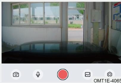
La grabadora de conducción está conectada a la unidad principal a través de Wi-Fi y se muestra y opera en la unidad principal. Haga clic en la aplicación de la grabadora de conducción para entrar en la pantalla en tiempo real de la misma. Deslice hacia adentro desde el borde izquierdo/derecho de la pantalla para regresar.
