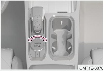
El sistema está en modo ECO por defecto cuando arranca el motor. Gire la perilla del modo de conducción entre el modo SPORT, el modo ECO o el modo NORMAL. Puede elegir según las diferentes condiciones de la carretera.
