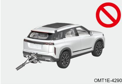
Cuando lave el vehículo, usa un paño suave o agua (baja presión de agua) para lavar la materia extraña como nieve, barro y polvo en la superficie del sensor de radar.
