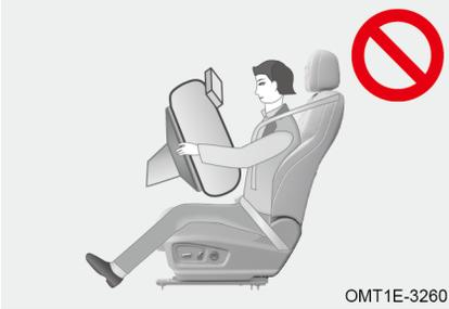
Mantenga siempre despejada la ruta de despliegue del airbag SRS. Está prohibido colocar cualquier objeto (como teléfono móvil) entre el ocupante y el airbag SRS y fijar o colocar cualquier objeto sobre o cerca de la cubierta del airbag SRS; Si se encuentra un objeto entre el ocupante y el airbag SRS, es posible que el airbag SRS no se despliegue de acuerdo con la ruta de diseño, o el airbag SRS puede empujar un objeto hacia el cuerpo del ocupante, causando lesiones graves o incluso la muerte.
