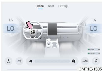
Después de arrancar el vehículo, presione "☺" en la pantalla del sistema de aire acondicionado para encender la función de calefacción del volante, presione nuevamente o trabaje durante aproximadamente 25 minutos, la función de calefacción del volante se apaga.
