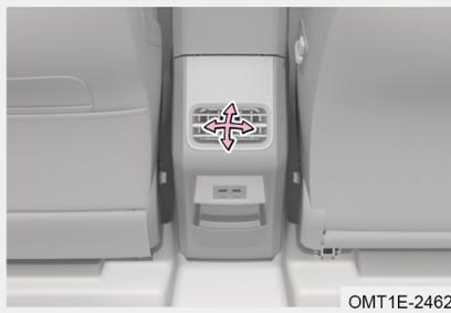
Mueva la palanca de ajuste de salida trasera hacia arriba, abajo, izquierda o derecha con la mano para ajustar la dirección del flujo de aire.
