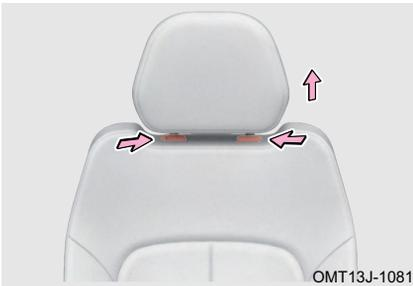
Desmontaje de reposacabezas: Tire del reposacabezas hacia arriba mientras presionando los dos botones de desbloqueo.
