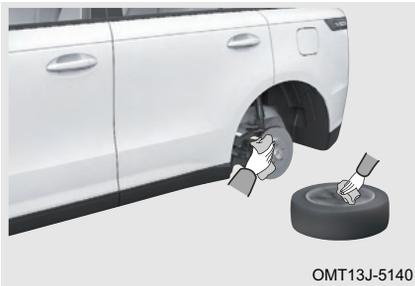
Paso 1: Retire todo accesorio de la superficie de montaje. Asegúrese de que el cubo de rueda contacte bien con la superficie de rueda e instale el neumático de repuesto;
