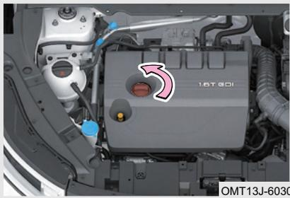
Paso 1: Para abrir la tapa del depósito de aceite de motor, gire la tapa en contra del sentido de las agujas del reloj;
