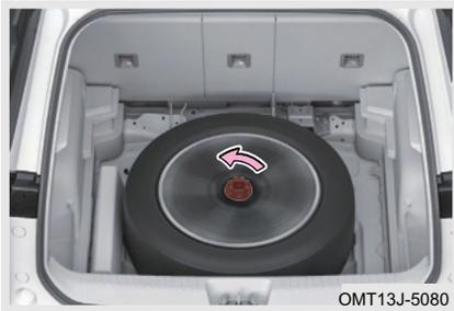
Paso 2: Gire el dispositivo de fijación del neumático de repuesto en sentido antihorario para retirarlo y luego saque el neumático.
