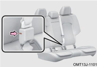
Al introducir la lengüeta pequeña en la hebilla pequeña del lado izquierdo del asiento de la segunda fila, utilice un destornillador con la punta envuelta en cinta adhesiva u objeto similar para presionar en la posición indicada en la ilustración y sacar la lengüeta pequeña.
