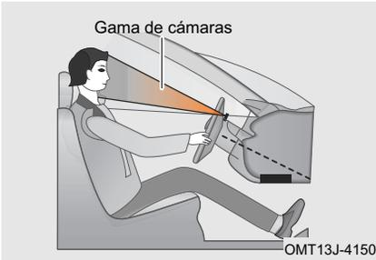
El sistema de monitoreo del conductor utiliza la cámara infrarroja dispuesta en el volante para monitorear y recopilar la imagen de la cara del conductor (como bostezos, ojos cerrados, asentir con la cabeza, etc.) e información del área de línea de visión en tiempo real, y recopile y juzgue el estado del conductor en tiempo real.
