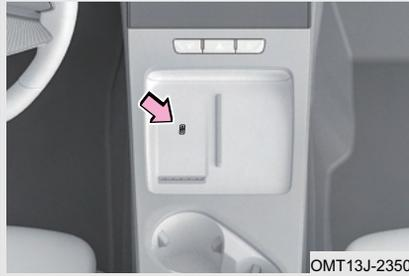
Mientras la energía del vehículo está en modo ON, la carga inalámbrica inicia a funcionar después de colocar el teléfono móvil en el área de detección de la carga inalámbrica, y la unidad principal de audio muestra "📶". La unidad principal de audio muestra "📶" después de que la carga está completa.
