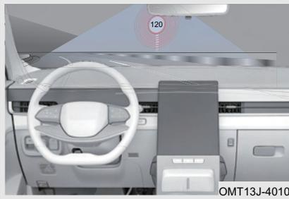
Después de que SLA detecta la información de la señal de límite de velocidad en la carretera de enfrente y combina la información con la información de límite de velocidad del sistema de navegación, el indicador "⊖" en el cuadro de instrumentos permanece encendido, si la velocidad excede el límite de velocidad actual en 5 km/h, el sonido de aviso sonará 1 vez.
