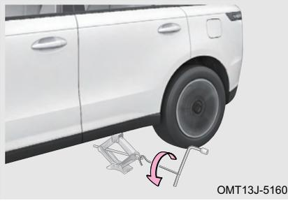
Paso 3: Asegúrese de que todas las personas alrededor del vehículo permanezcan en el área segura, coloque el balancín en el gato y la llave de perno de rueda en el balancín, y gire la llave de perno de rueda en sentido antihorario para bajar el vehículo;
