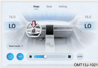
Después de arrancar el vehículo, pulse "☺" en la pantalla del sistema de aire acondicionado para activar la función de calefacción del volante. Después de volver a pulsar el botón, la función de calefacción del volante se desactiva.
