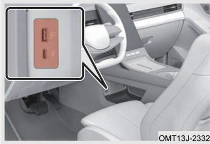
El puerto USB está situado en la parte delantera inferior de la consola de fascia auxiliar.
