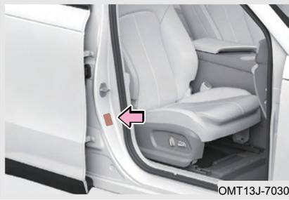
La etiqueta de producto del vehículo se encuentra en el panel exterior del cuarto derecho, como se muestra en la ilustración.
