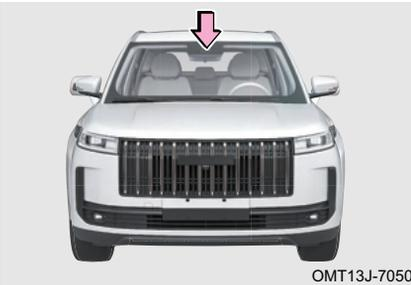
La ventana de microondas está ubicada en el lado derecho en la parte posterior del parabrisas delantero dentro del espejo retrovisor donde es para la transmisión inalámbrica de señal RF y la instalación de identificación electrónica automotriz.
