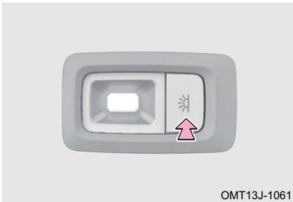
Presione el interruptor de la luz de techo trasera, la luz se enciende, y presione el interruptor nuevamente para apagar la luz.
