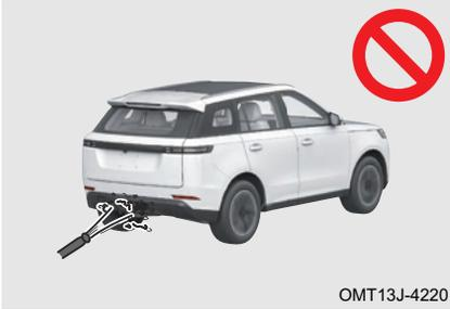
Cuando lave el vehículo, use un paño suave o agua (baja presión de agua) para lavar la materia extraña como nieve, barro y polvo en la superficie del sensor de radar.
