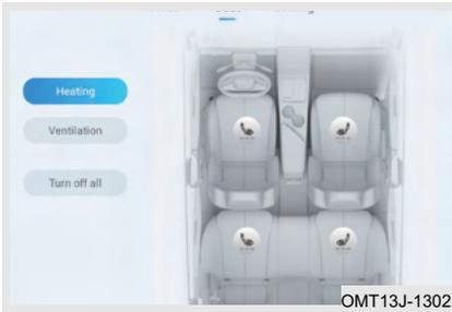
Después de arrancar el vehículo, haga clic en el botón del calentador del asiento delantero en la pantalla de visualización del aire acondicionado - asiento - calefacción, es calefacción del nivel 3 (3 indicadores encendidos). Cada vez que se pulsa el interruptor, el nivel de calefacción baja un nivel. Si se pulsa por cuarta vez, se desactiva la calefacción del asiento.
