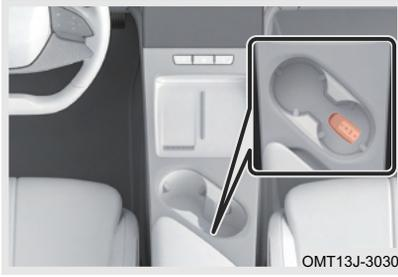
Paso 1: Coloque la llave inteligente en la marca de la llave de portavasos de la consola auxiliar (como se muestra en la figura) con la cara frontal hacia arriba; No pise el pedal del freno en este momento;
