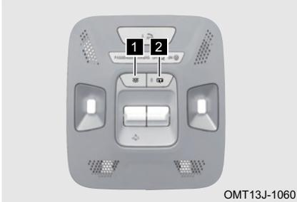
**1** Interruptor de luces de lectura: Presione el interruptor "☀️" para encender las luces de lectura, presione el interruptor nuevamente para apagar las luces de lectura.
