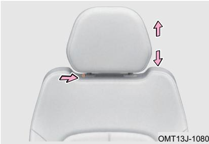
Ajuste el reposacabezas hacia arriba: Tire hacia arriba directamente a la altura adecuada.
