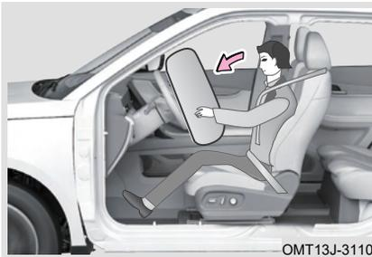
El airbag SRS funciona junto con el cinturón de seguridad para proteger la seguridad del conductor y de los pasajeros. Sin embargo, el airbag no es un sustituto del cinturón de seguridad. Además, el airbag SRS se desplegará solo cuando el grado de colisión del vehículo alcance la condición del diseño. En algunas colisiones, el cinturón de seguridad es el único aparato de protección.
