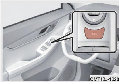
Operar con el interruptor: Cuando la energía del vehículo se cambia al modo ON, presione el interruptor de plegado del espejo retrovisor exterior para plegar los espejos automáticamente, presione el interruptor nuevamente para extender los espejos automáticamente.
