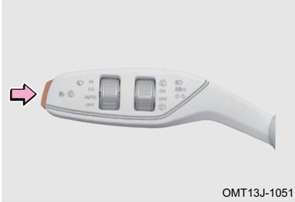
El vehículo está encendido, pulse brevemente el botón izquierdo, el limpiaparabrisas se detendrá después de limpiar una vez; Presione y mantenga presionado el botón, el lavaparabrisas delantero rocía agua, y el limpiaparabrisas delantero funciona simultáneamente. después de soltar, el lavaparabrisas delantero deja de funcionar y el limpiaparabrisas funcionará varias veces.
