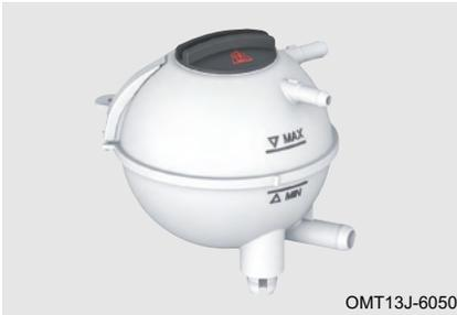
Cuando el motor está frío, el nivel de refrigerante debe estar entre las marcas "MIN" y "MAX". Si el nivel es igual o inferior a la marca "MIN", agregue el refrigerante y contacte con la estación de servicio autorizada para una inspección y reparación de inmediato.
