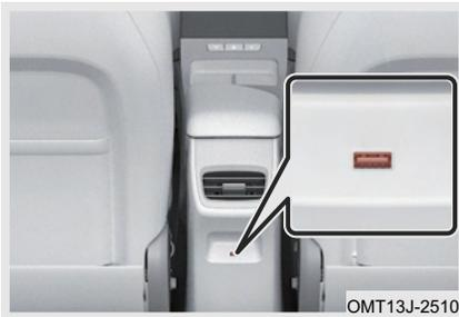
El puerto USB trasero se puede utilizar para cargar el equipo eléctrico con baja potencia, como teléfono, etc.
