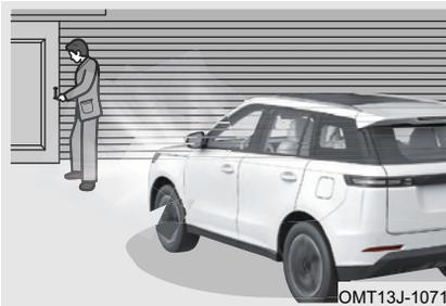
Encendido: Cambie la alimentación del vehículo al modo OFF y gire el interruptor de combinación de faros delanteros a la posición "AUTO". Cuando el vehículo está en un ambiente oscuro, presione el botón de bloqueo en la llave inteligente, el vehículo se bloquea con éxito. Las luces de cruce se encienden automáticamente por 27 segundos. Presione el botón de bloqueo en la llave inteligente para activar nuevamente.
