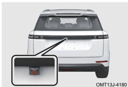
Posición de instalación de cámara trasera: ubicada en la parte central sobre la placa de matrícula trasera.
