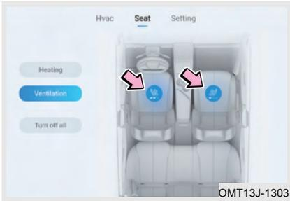
Después de arrancar el vehículo, haga clic en el botón de ventilación del asiento por la pantalla de visualización del aire acondicionado - asiento - ventilar, es la ventilación del nivel 3 (se encienden 3 indicadores). Cada vez que se pulsa el interruptor, el nivel de ventilación se reduce en un nivel; púlselo por cuarta vez para desactivar la ventilación del asiento.
