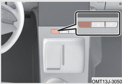
El sistema está en modo ECO por defecto cuando arranca el motor. Presione el botón de alternancia entre el modo DEPORTIVO, el modo ECO o el modo NORMAL. Puede elegir según las diferentes condiciones de la carretera.
