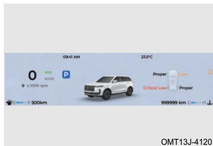
Para el sistema de monitoreo de presión de neumáticos, cuando la presión de inflado de uno o más neumáticos es insuficiente o la temperatura es demasiado alta, el indicador amarillo "(!)" en el cuadro de instrumentos permanece encendido.
