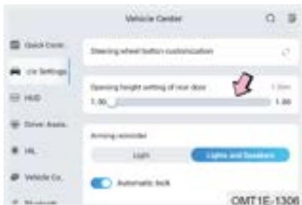
Método 2: Gire la alimentación del vehículo en el modo ON, ajuste la altura de apertura mediante el Sistema de Audio - Centro del Vehículo - Ajustes del Vehículo.
