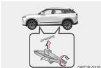
Paso 3: Coloque el gato en el terreno firme y nivelado, gire la manija del gato hacia la derecha con la mano, haciendo que la muesca de del gato contacte con el punto de levantamiento correcto.
