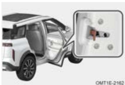
Cuando la batería se agota o se encuentra en una situación similar, el vehículo no puede bloquearse con energía eléctrica, en cuyo caso la puerta se puede bloquear con una función de bloqueo de emergencia.
