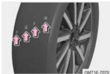
Compruebe la banda de rodadura del neumático por la marca de desgaste de la banda de rodadura. Cuando el desgaste de la banda de rodadura alcanza el límite, la banda de rodadura estará en el mismo plano que la banda de desgaste. Si se produce esta situación, el rendimiento y la seguridad del neumático se verán gravemente afectados y será necesario sustituirlo.
