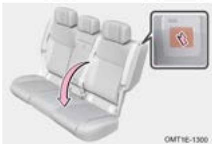
Ajuste la altura de reposacabezas del asiento, retírelo si es necesario y pliegue el apoyabrazos central. Luego tire de la palanca de ajuste del respaldo izquierdo hacia adelante y tire del respaldo hacia adelante para plegarlo lentamente. Esto puede ampliar el espacio de almacenamiento de equipaje.
