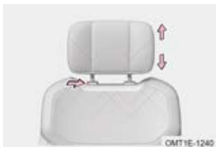
Ajuste el reposacabezas hacia arriba: Tire hacia arriba directamente a la altura adecuada.
