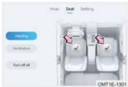
Método 1: Despues de arrancar el vehículo, haga clic en el botón del calentador del asiento delantero en la pantalla de visualización del aire acondicionado - asiento - calefacción, es calefacción del nivel 3 (3 indicadores encendidos). Cada vez que se pulsa el interruptor, el nivel de calefacción baja un nivel. Si se pulsa por cuarta vez, se desactiva la calefacción del asiento.
