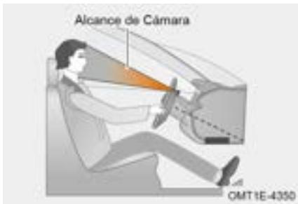
El sistema de monitoreo del conductor utiliza la cámara infrarroja dispuesta en el volante para monitorear y recopilar la imagen de la cara del conductor (como bostezos, ojos cerrados, asentir con la cabeza, etc.) e información del área de línea de visión en tiempo real, y recopile y juzgue el estado del conductor en tiempo real.
