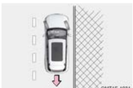
Si hay un bordillo en el borde de la carretera, gire el volante hacia la izquierda para asegurarse de que la parte trasera de la rueda delantera derecha está cerca o contra el bordillo, para evitar que el vehículo se deslice hacia atrás por la pendiente, y luego ponga el freno de mano.
