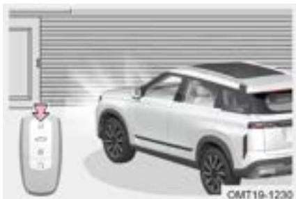
Gire el interruptor de combinación de faros a la posición "AUTO" antes de detenerse. Cuando el vehículo está en un ambiente oscuro, presione el botón de desbloqueo en la llave inteligente, las luces bajas se encienden durante 27 segundos.
