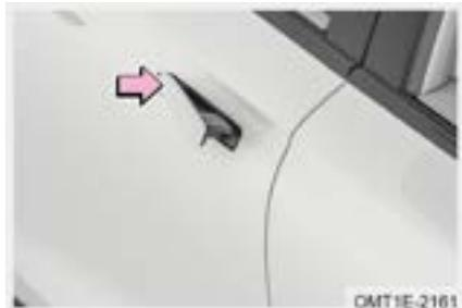
Paso 1: Presione y sostenga el área frontal de la manija exterior de la puerta del conductor para abrir la manija oculta de la puerta.
