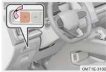
Cuando la energía del vehículo se cambia al modo ON o el motor se arranca y el vehículo se detiene, tire del botón del freno de estacionamiento eléctrico, el indicador rojo "(P)" en el cuadro de instrumentos y el indicador del botón del freno de estacionamiento eléctrico permanece encendido, indicando que la función del freno de estacionamiento se ha activado.
