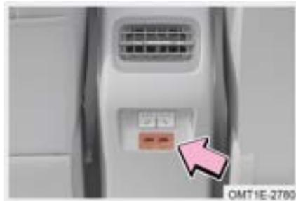
El puerto USB trasero se puede utilizar para cargar el equipo eléctrico con baja potencia, como teléfono, etc.
