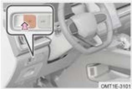
Con que arranque el motor o cambie la fuente del vehículo al modo ON, pise el pedal del freno y presione el botón del freno de estacionamiento eléctrico manualmente, el indicador rojo " (P) " en el cuadro de instrumentos y el indicador del botón del freno de estacionamiento eléctrico se apagarán, indicando que está liberada la función del freno de estacionamiento.
