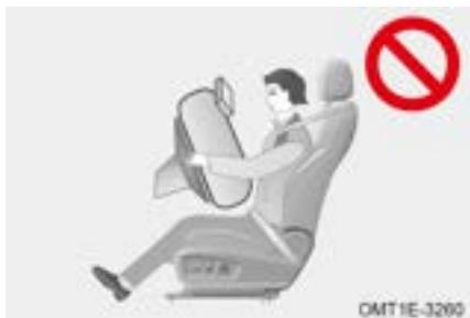
Mantenga siempre despejada la ruta de despliegue del airbag SRS. Está prohibido colocar cualquier objeto (como teléfono móvil) entre el ocupante y el airbag SRS y fijar o colocar cualquier objeto sobre o cerca de la cubierta del airbag SRS; Si se encuentra un objeto entre el ocupante y el airbag SRS, es posible que el airbag SRS no se despliegue de acuerdo con la ruta de diseño, o el airbag SRS puede empujar un objeto hacia el cuerpo del ocupante, causando lesiones graves o incluso la muerte.
