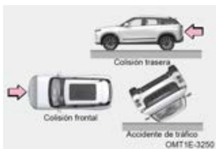
Es posible que los airbags laterales, los airbags de cortina y el airbag central delantero no se desplieguen si el vehículo sufre una colisión frontal o trasera, un vuelco o una colisión lateral a baja velocidad.
