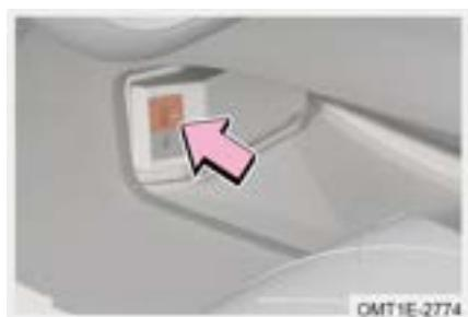
Paso 3: Conecte el puerto USB y el teléfono con el cable de datos del teléfono original;
