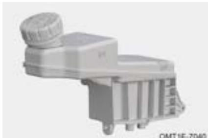
El nivel de líquido de frenos debería encontrarse entre las marcas "MIN" y "MAX". Si el nivel es igual o inferior a la marca "MIN", agregue el líquido de frenos y contacte con la estación de servicio autorizada para su inspección y reparación de inmediato.
