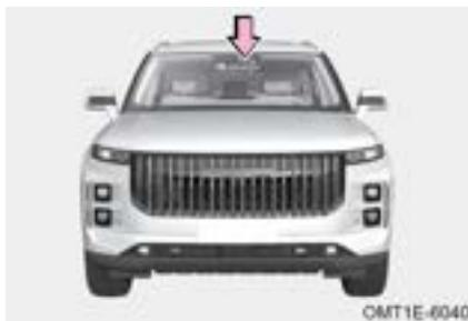
La ventana de microondas está ubicada en el lado derecho en la parte posterior del parabrisas delantero dentro del espejo retrovisor donde es para la transmisión inalámbrica de señal RF y la instalación de identificación electrónica automotriz.
