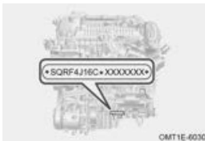
El número de motor se encuentra en el bloque del motor como se muestra en la ilustración.
