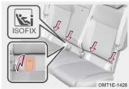
Los asientos traseros exteriores están equipados con anclajes ISOFIX/i-Size. Los lugares de anclaje están identificados por una marca (véase la ilustración) situada en el respaldo del asiento, directamente encima de los anclajes asociados. Levante o retire la cubierta ISOFIX para acceder a los anclajes.
