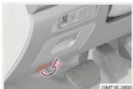
Paso 1: Tire de la palanca de liberación del capó y el capó se levantará ligeramente; Tire de él de nuevo y el capó se levanta un poco más.
