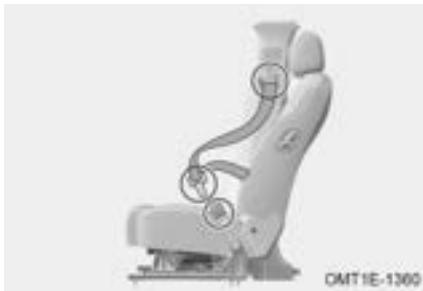
Compruebe los cinturones de seguridad regularmente en busca de cortes, deshilachados, cinturones sueltos o estirados (por ejemplo, después de un accidente de tráfico) si el cinturón de seguridad está dañado, por favor comuníquese con la estación de servicio autorizada para una inspección y reparación inmediatamente.
