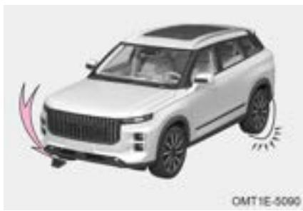
Paso 1: Coloque un bloque debajo del neumático diagonalmente opuesto al neumático desinflado para evitar que el vehículo ruede.
