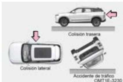
El airbag del conductor, el airbag del pasajero delantero y el airbag de rodillas del conductor (si está equipado) generalmente no se desplegarán si el vehículo está involucrado en una colisión lateral o trasera, si se vuelca o si está involucrado en una colisión frontal a baja velocidad.
