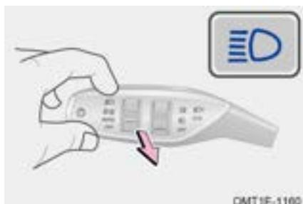
Tire del interruptor de combinación de faros hacia el volante y suéltelo para parpadearse las luces altas una vez. Al mismo tiempo, el indicador de luz alta de faro en el cuadro de instrumentos se parpadea una vez.
