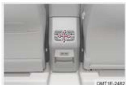
Mueva la palanca de ajuste de salida trasera hacia arriba, abajo, izquierda o derecha con la mano para ajustar la dirección del flujo de aire.
