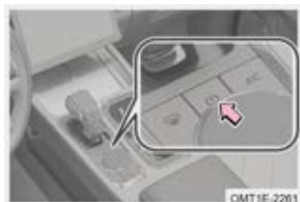
Presione el botón de encendido en la consola auxiliar para encender/apagar el sistema de audio.
