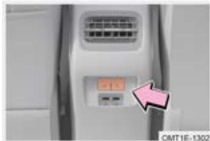
Método 2: Después de arrancar el vehículo, presione el interruptor del calentador del asiento trasero, es la calefacción del nivel 3 (3 indicadores encendidos). Cada vez que se pulsa el interruptor, el nivel de calefacción se reduce en un nivel. Púlselo por cuarta vez para desactivar la calefacción del asiento.
