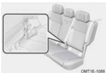
Al introducir la lengüeta pequeña en la hebilla pequeña del lado izquierdo del asiento de la segunda fila, utilice un destornillador con la punta envuelta en cinta adhesiva u objeto similar para presionar en la posición indicada en la ilustración y sacar la lengüeta pequeña.
