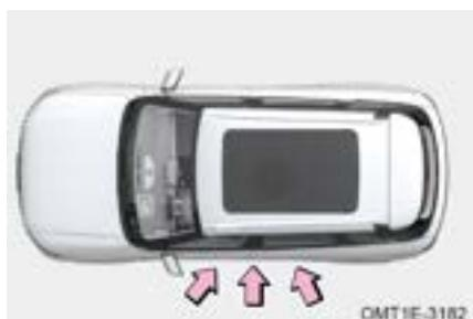
El vehículo está sujeto a un fuerte impacto lateral, y los sensores de colisión lateral detectan un impacto lo suficientemente grave como para hacer que se desplieguen los airbags laterales, los airbags de cortina y el airbag delantero central.
