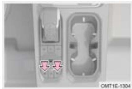
Método 2: Despues de arrancar el vehículo, presione el interruptor de la calefacción del asiento delantero en la consola auxiliar del tablero, es la calefacción del nivel 3 (3 indicadores encendidos). Cada vez que se pulsa el interruptor, el nivel de calefacción se reduce en un nivel. Púlselo por cuarta vez para desactivar la calefacción del asiento.
