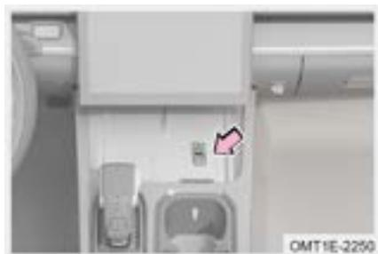
Mientras la energía del vehículo está en modo ON, la carga inalámbrica inicia a funcionar después de colocar el teléfono móvil en el área de detección de la carga inalámbrica, y la unidad principal de audio muestra "充满". La unidad principal de audio muestra "充满" después de que la carga está completa.
