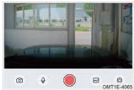
La grabadora de conducción está conectada a la unidad principal a través de Wi-Fi y se muestra y opera en la unidad principal. Haga clic en la aplicación de la grabadora de conducción para entrar en la pantalla en tiempo real de la misma. Deslice hacia adentro desde el borde izquierdo/derecho de la pantalla para regresar.
