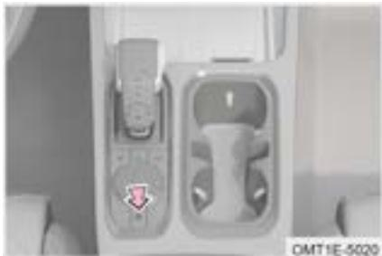
En caso de falla del vehículo o accidente de tráfico, etc., encienda las luces de peligro para advertir a otros vehículos para evitar accidente secundario.
