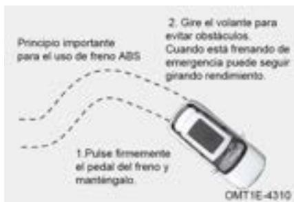
ABS no funciona durante el frenado normal y se encenderá inmediatamente solo en el frenado repentino (el pedal del freno se pulsa con ruido, asegurando el rendimiento del freno y el rendimiento de la dirección, si el espacio es suficiente, el vehículo también puede evitar obstáculos). Nunca suelte el pedal del freno en este caso.
