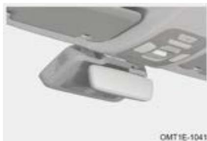
Cuando conduce por la noche, el sensor de luz instalado en la parte delantera/trasera del espejo retrovisor interior detecta automáticamente la luz reflejada de los faros de vehículos detrás y ajusta automáticamente el ángulo de lente para reducir la luz reflejada desde los faros de vehículos detrás.
