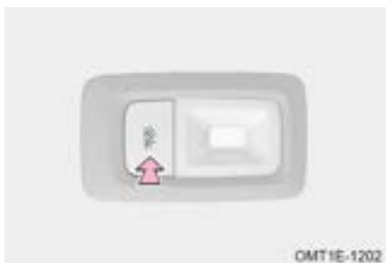
Presione el interruptor de la luz de techo trasera, la luz se enciende, y presione el interruptor nuevamente para apagar la luz.
