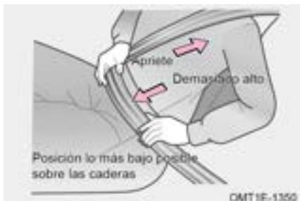
Para ajuste el ángulo del respaldo, siéntese rectamente y recuéstese bien en el asiento. Coloque el cinturón de regazo lo más bajo posible en sus caderas, no en su cintura, luego tire de la sección del hombro hacia arriba para que se quede completamente sobre el hombro, pero no entre en contacto con el cuello ni se desliza fuera del hombro.
