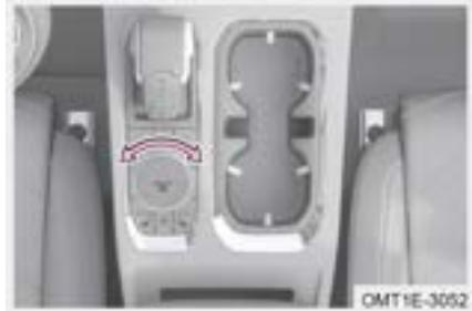
Gire la perilla del modo de conducción o ajuste el modo de conducción en el la unidad principal, el icono del modo correspondiente en el cuadro de instrumentos aparecerá acompañado de un recordatorio de voz para indicarle que el modo de conducción se ha cambiado correctamente.
