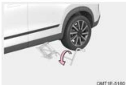
Paso 3: Asegúrese de que todas las personas alrededores del vehículo permanezcan en el área segura, coloque el balancín en el gato y la llave de perno de rueda en el balancín, y gire la llave de perno de rueda en sentido antihorario para bajar el vehículo;
