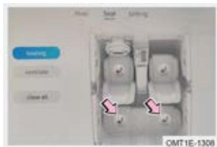
Método 1: Despues de arrancar el vehículo, haga clic en el botón del calentador del asiento trasero en la pantalla de visualización del aire acondicionado - asiento - calefacción, es calefacción del nivel 3 (3 indicadores encendidos). Cada vez que se pulsa el interruptor, el nivel de calefacción baja un nivel. Si se pulsa por cuarta vez, se desactiva la calefacción del asiento.
