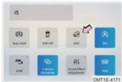
Con la alimentación del vehículo en modo ON, deslícese hacia abajo desde el borde superior derecho de la pantalla del sistema de audio para mostrar la pantalla del menú de acceso directo.
