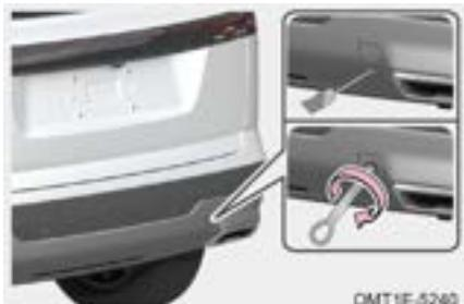
Paso 1: Retire la tapa del ojal del remolque trasero usando el destornillador con cinta.
