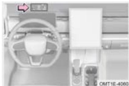
Cuando la pantalla de visualización frontal está encendida, se forma una imagen virtual frente al campo de visión del conductor para mostrar la velocidad correspondiente del vehículo, el kilometraje de conducción y otra información.
