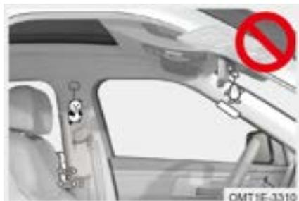
No ponga nada en áreas tales como la puerta, el vidrio del parabrisas, el vidrio de la puerta lateral, el pilar A, el pilar B, el pilar C, el riel de lado de del techo y el asa de apoyo.
