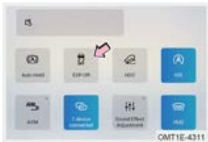
Gire la fuente de alimentación del vehículo en el modo ON, deslícese hacia abajo desde el borde superior derecho de la pantalla del sistema de audio, haga clic en el interruptor ESP OFF para apagar ESP; haga clic en el interruptor ESP OFF nuevamente para encender ESP.
