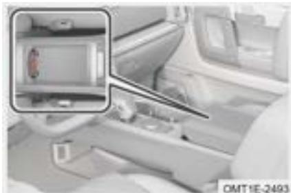
Coloque los artículos necesarios (Por ejemplo: Bebidas enlatadas) en la caja de reposabrazos de la consola auxiliar para realizar la operación de enfriamiento de A/C. Gire el botón interior de la caja de reposabrazos para enfriar los artículos necesarios.
