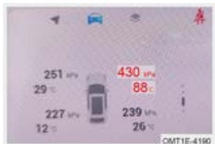
Cuando la temperatura de neumático es superior a 85°C y la velocidad no es inferior a 25 km/h por un período de tiempo, el sistema enviará una advertencia de alta temperatura, el símbolo de la rueda correspondiente parpadeará, se mostrará el valor actual de la temperatura de neumático y el indicador amarillo "(!)" en el cuadro de instrumentos permanecerá encendido.
