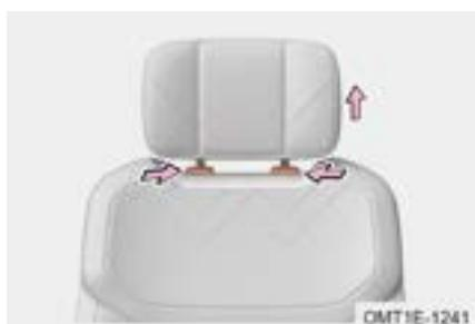
Desmontaje de reposacabezas: Tire del reposacabezas hacia arriba mientras presionando los dos botones de desbloqueo.
