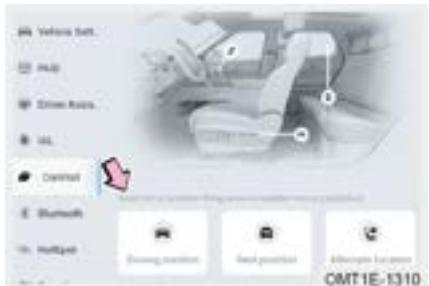
Gire la alimentación del vehículo en el modo ON, el sistema de audio mostrará la pantalla de confort del vehículo, seleccione la Posición de conducción, Posición de descanso o Ubicación alternativa, presione largamente para actualizar y memorizar.
