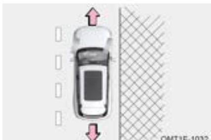
Si no hay un bordillo en el borde de la carretera, gire el volante con fuerza hacia la derecha para evitar que el vehículo se dirija al centro de la carretera o se deslice por la pendiente. Gire el volante hacia el lado de la carretera, de modo que el vehículo esté orientado hacia el centro de la carretera cuando se mueva, y luego ponga el freno de estacionamiento.
