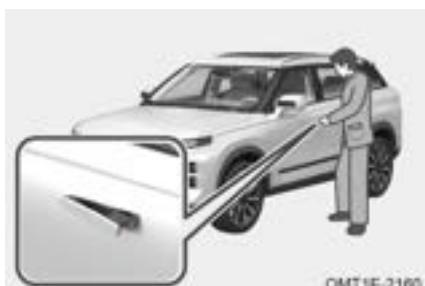
Paso 2: Tire de la manija de la puerta, inserte la llave mecánica en el orificio de la cerradura dentro de la manija de la puerta, gire en sentido horario para bloquear la puerta, en sentido antihorario para desbloquear la puerta.
