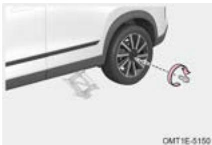
Paso 2: Cuando instala los pernos de rueda, atornille todos los pernos de rueda en sentido horario con la mano. Luego enderece el neumático de repuesto y apriete previamente todos los pernos de rueda con la llave de perno de rueda;
