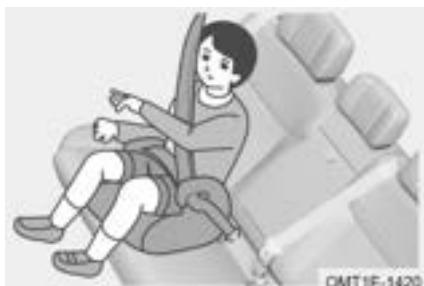
En el caso de los niños más grandes que no caben en un sistema de retención infantil con respaldo alto, pueden ocupar un asiento exterior de la segunda fila utilizando un asiento elevador, ya sea fijado en los puntos de anclaje inferiores o con cinturón, como se describe en las instrucciones proporcionadas por el fabricante del sistema de retención infantil.
