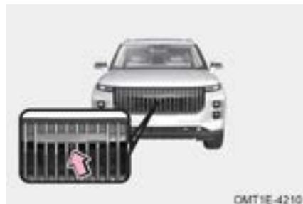
Posición de instalación de la cámara frontal: ubicada en la rejilla de admisión del parachoques delantero.
