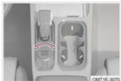
El sistema está en modo ECO por defecto cuando arranca el motor. Gire la perilla del modo de conducción entre el modo SPORT, el modo ECO o el modo NORMAL. Puede elegir según las diferentes condiciones de la carretera.
