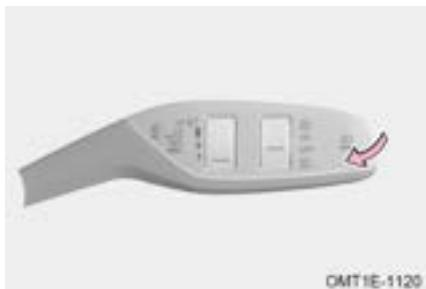
Cambie la fuente del vehículo al modo ON, tire del interruptor de combinación del limpiaparabrisas hacia el volante y sosténgalo, la lavadora delantera rocía agua y el limpiaparabrisas delantero funciona simultáneamente. La lavadora delantera dejará de funcionar cuando se suelte el interruptor, el limpiaparabrisas limpiará 3 ciclos a baja velocidad, y funciona un ciclo luego se detiene después de unos segundos.
