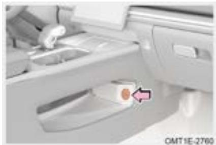
La toma de corriente delantera está situada en la parte delantera inferior de la consola de fascia auxiliar.
