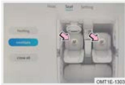
Después de arrancar el vehículo, haga clic en el botón de ventilación del asiento por la pantalla de visualización del aire acondicionado - asiento - ventilar, es la ventilación del nivel 3 (se encienden 3 indicadores). Cada vez que se pulsa el interruptor, el nivel de ventilación se reduce en un nivel; púlselo por cuarta vez para desactivar la ventilación del asiento.
