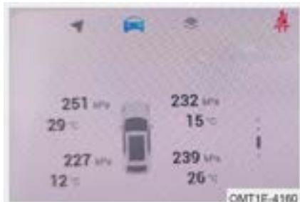
Cuando la velocidad de conducción del vehículo es superior a 30 km/h y el tiempo de conducción continua es superior a 45 s, el cuadro de instrumentos puede mostrar los valores de la presión y la temperatura de los neumáticos en tiempo real.
