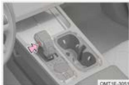
Modo manual: Cuando la marcha de la transmisión está en D, mantenga pulsado el interruptor M para entrar en el modo manual M (+, -), empuje hacia delante para subir una marcha y empuje hacia atrás para bajar una marcha.
