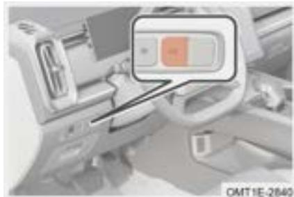
Con el bloqueo de control central desbloqueado, presione largamente el interruptor "↗", las luces de señal de giro se encenderán y el portón trasero eléctrico se abrirá/cerrará.
