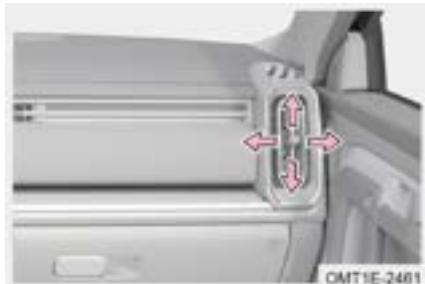
Mueva la palanca de ajustamiento de salida lateral izquierdo/derecho hacia arriba, abajo, izquierda o derecha con la mano para ajustar la dirección del flujo de aire.
