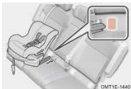
Paso 2: Levante o retire la cubierta del anclaje ISOFIX;
