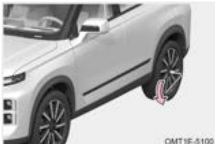
Paso 2: Coloque la llave de perno de rueda en el perno del neumático desinflado, coloque la manija en el lado izquierdo, sostenga el extremo de la llave y empuje hacia abajo, afloje cada perno del neumático desinflado aproximadamente media vuelta;
