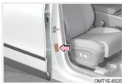
La etiqueta de producto del vehículo se encuentra en el panel exterior del cuarto derecho, como se muestra en la ilustración.
