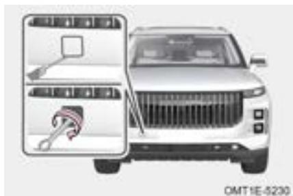
Paso 1: Retire la tapa del ojal del remolque delantero usando el destornillador con cinta;
