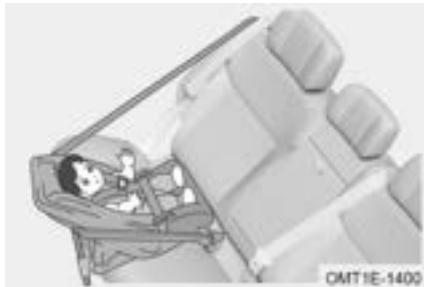
Un sistema de retención infantil orientado hacia atrás se instala para mirar hacia la parte trasera del vehículo. Instale un sistema de retención infantil orientado hacia atrás en el asiento del acompañante sólo si el airbag está desactivado. Se recomienda que los niños utilicen un sistema de retención infantil orientado hacia atrás hasta los 4 años de edad.
