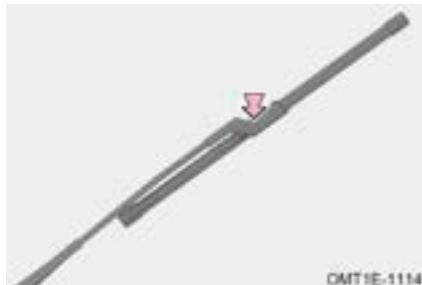
Paso 1: Accione el limpiaparabrisas delantero en los 3 segundos siguientes a la desconexión del apagar el interruptor de arranque y parada del motor, el limpiaparabrisas entrará en modo de reparación;
