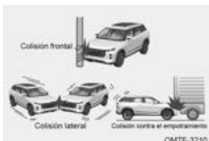
Es posible que el airbag del conductor, el airbag del pasajero delantero y el airbag de rodillas del conductor (si está equipado) no se desplieguen si la parte delantera del vehículo golpea un poste de telégrafo, pase debajo de un camión, o si el vehículo esté involucrado en una colisión lateral.
