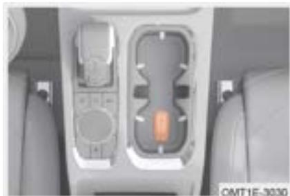
Paso 1: Coloque la llave inteligente en la marca de la llave de portavasos de la consola auxiliar (como se muestra en la figura) con la cara frontal hacia arriba; No pise el pedal del freno en este momento;
