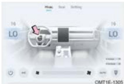
Después de arrancar el vehículo, presione "Heat" en la pantalla del sistema de aire acondicionado para encender la función de calefacción del volante, presione nuevamente o trabaje durante aproximadamente 25 minutos, la función de calefacción del volante se apaga.
