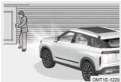
ON: Cambie la fuente del vehículo al modo OFF y gire el interruptor de combinación de faros delanteros a la posición "AUTO". Cuando el vehículo está en un ambiente oscuro, presione el botón de bloqueo en la llave inteligente, el vehículo se bloqueo con éxito. Las luces bajas se encienden automáticamente por 27 segundos. Presione el botón de bloqueo en la llave inteligente para activar nuevamente.
