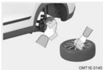
Paso 1: Retire todo accesorio de la superficie de montaje. Asegúrese de que el cubo de rueda contacte bien con la superficie de rueda e instale el neumático de repuesto;
