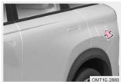
Paso 1: Despues de desbloquear el vehículo, empuje la tapa del tanque de combustible y se abrirá;
