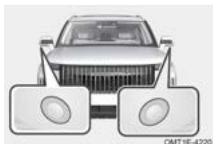
Posición de instalación de las cámaras izquierda/derecha: ubicada en la parte inferior de los espejos retrovisores exteriores izquierdo/derecho.
