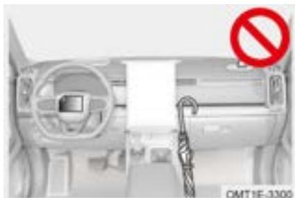
No ponga nada ni apoye nada contra las áreas tales como el panel de instrumentos, el volante y la parte inferior del tablero de instrumentos. Estos elementos pueden convertirse en proyectiles cuando se despliega el airbag del conductor o el pasajero delantero.
