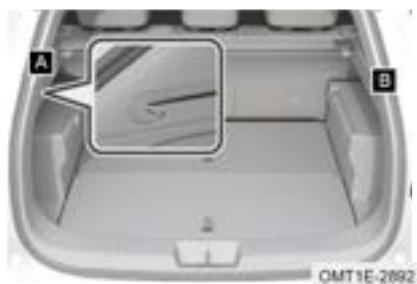
Tire de la cortina de equipaje hacia las ranuras del punto A y el punto B para sujetarla, y confirme que si está sujetado adecuadamente.
